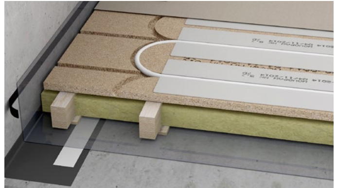
Figur 4 Klimagulve lægges med kantstrø 35 mm c-c langs alle vægge og med ekstra strø under vendespor.
